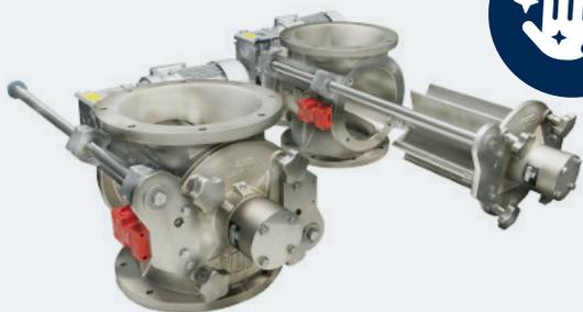
Eine neue, schnelldemontierbare Variante der bewerteten HT-S Schleuse. Dieses HT-S Easy Clean kombiniert die Eigenschaften des HT-S mit einem hohen Maß an Reinigungseffizienz, da der Rotor einfach und ohne Werkzeug entfernt und zurückgesetzt werden kann. Gehäuse innen und außen chemisch vernickelt, geeignet beispielsweise für Lebensmittel. Der gegossene Rotor aus Edelstahl 1.4571 besteht aus einem Stück mit einem Edelstahlschlitten mit Aluminiumlagergehäusen.
