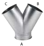
B Broekstukken Gegalvaniseerde broekstukken in 30° en 45° met een plaatdikte van 0,9 mm. Grotere diameters op aanvraag.
